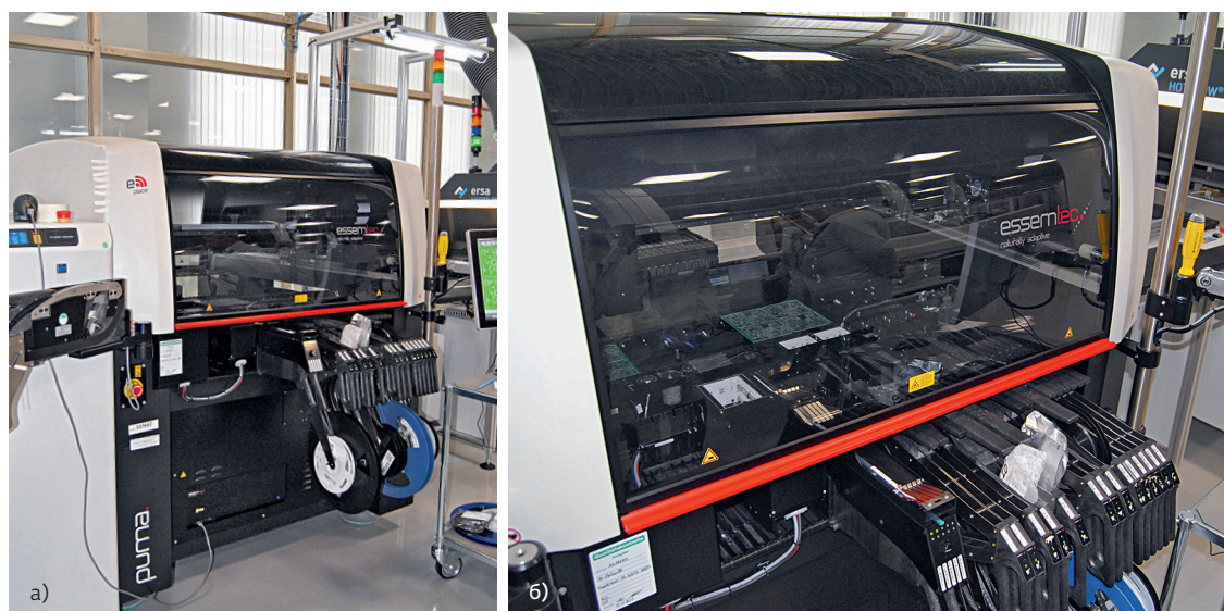
Универсальный сборочный центр Essemtec Puma: а – общий вид; б – рабочая зона и питатели
