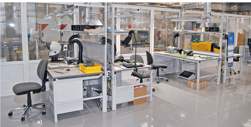
Участок ручного монтажа: а – рабочие места; б – ремонтный центр HR550 компании ERSA
