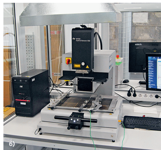
Участок ручного монтажа: а – рабочие места; б – ремонтный центр HR550 компании ERSA
