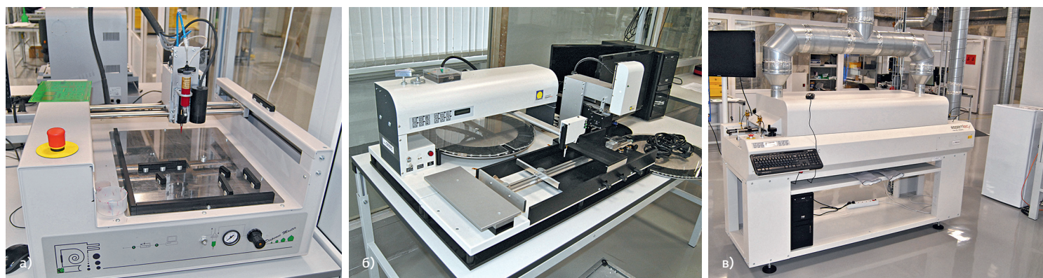
Первый комплект оборудования для поверхностного монтажа: а – система дозирования Dispence Master DD-500 (DIMA, Нидерланды); б – манипулятор Powatec (Essemtec, Швейцария); в – конвекционная печь RO300FC с тремя зонами нагрева и одной зоной охлаждения (Essemtec)
