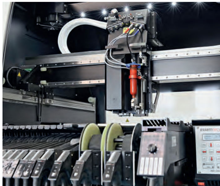
Essemtec Fox: в автомате опционально может быть использовано до двух систем дозирования, в том числе шнековые и каплеустройные для нанесения паяльной пасты
