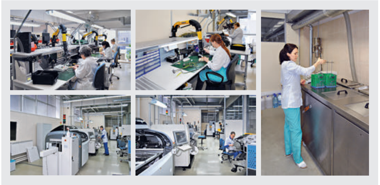
Производство электронных узлов. Рабочие места ручного монтажа; автоматизированная сборочная линия; рабочее место подготовки питателей, установка ультразвуковой отмычки печатных узлов Miniclean компании PBT Works
