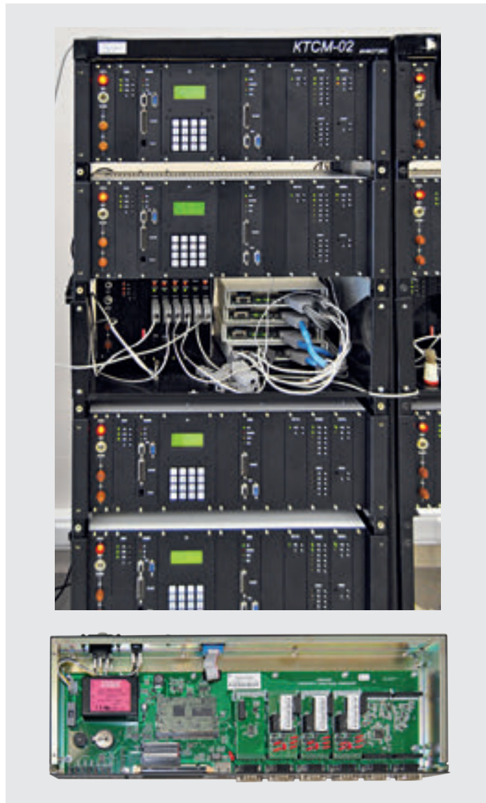
Аппаратура КТСМ: сверху – комплект стойки КТСМ-02; снизу – один из модулей аппаратуры в процессе сборки
