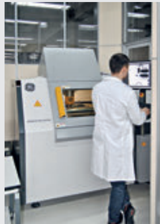
Контроль качества изготовления печатных узлов: АРИ Phoenix Microtelx DXR-HD, АОИ Viscom s3088 Ultra blue
