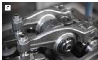
11 Модель двигателя A ; модель двигателя с деталями, которые предлагается изготавливать по аддитивным технологиям B ; коромысло, выполненное литьем C ; напечатанное коромысло D . Источник: Renault Trucks
