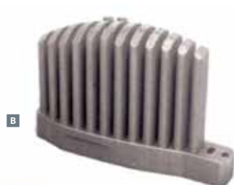
7 Модель и напечатанная вставка в форму с каналами охлаждения. Источник: Renishaw
