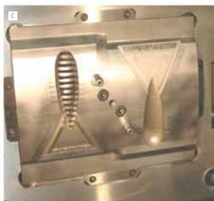
8 Модель вставки A , вставка, напечатанная на 3D-принтере B , пресс-форма C , скребок для льда D . Источник: Renishaw
