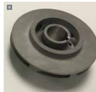
15 Оригинальный изношенный импеллер насоса системы пожаротушения атомной электростанции в Кршко, Словения A ; напечатанный импеллер B . Источник: Siemens
