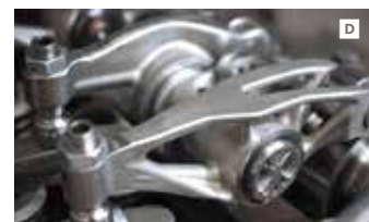
11 Модель двигателя A ; модель двигателя с деталями, которые предлагается изготавливать по аддитивным технологиям B ; коромысло, выполненное литьем C ; напечатанное коромысло D . Источник: Renault Trucks
