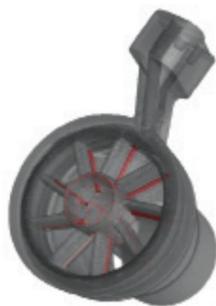
Рис. 5. Горелочное устройство, произведенное методом аддитивных технологий
