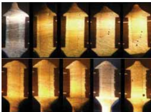
Рис. 30 Поперечное сечение ПУ спаянного на установке А
