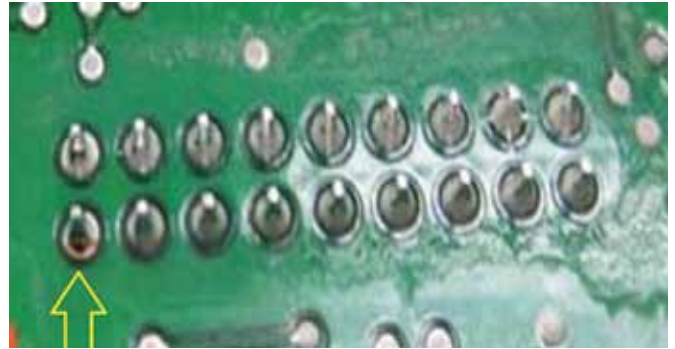
Рис. 22 Плохое качество пайки вывода компонента
