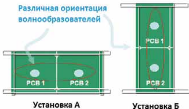
Рис. 1 Загрузка ПУ и ориентация волнообразователей
