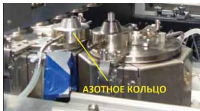
Рис. 14 Подача азота в установке Б
