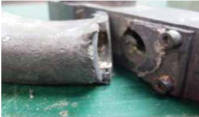
Рис. 7 Сломанная деталь насоса (установка А)
