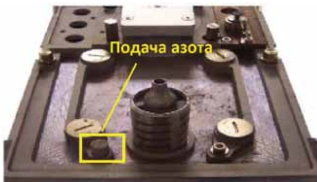
Рис. 13 Подача азота в установке А
