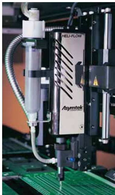
Рис. 2 Прецизионная шнековая головка DV7000
