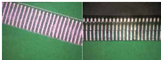
Рис. 5 Нанесение пасты и оплавление компонента QFP с шагом 0,3
