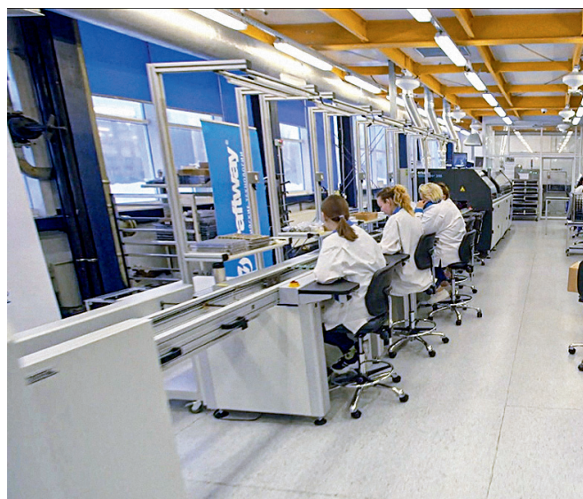
Рабочие места установки штыревых компонентов в линии перед селективной пайкой
