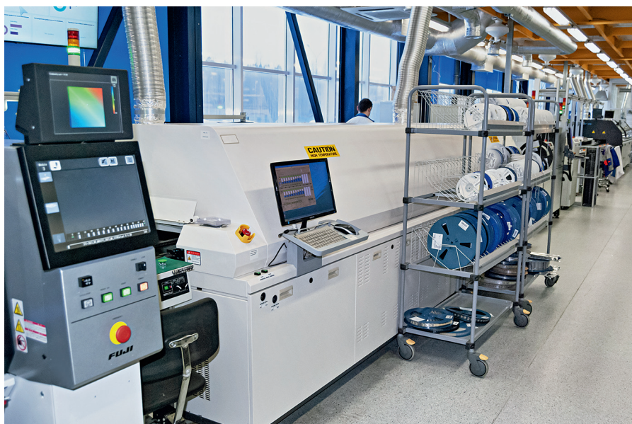
Печь конвекционного оплавления в линии
