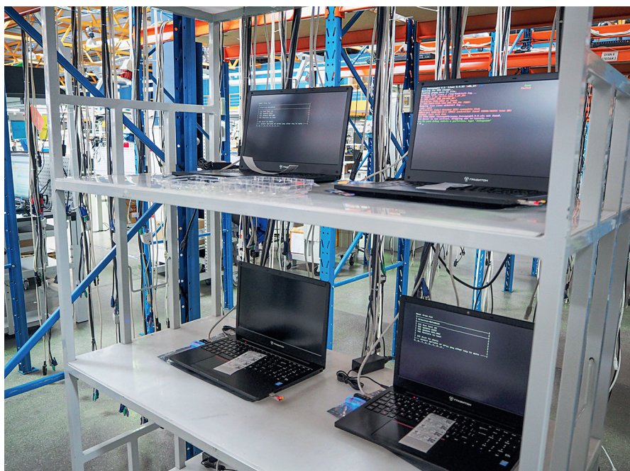
Ноутбуки в процессе финального тестирования
