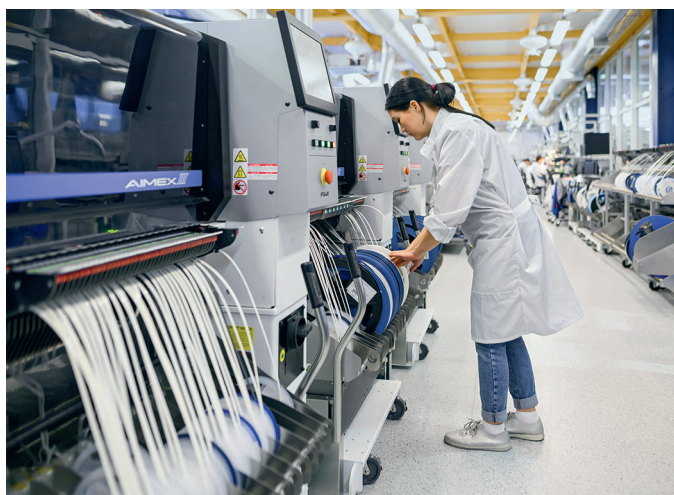
Участок сборки печатных узлов
