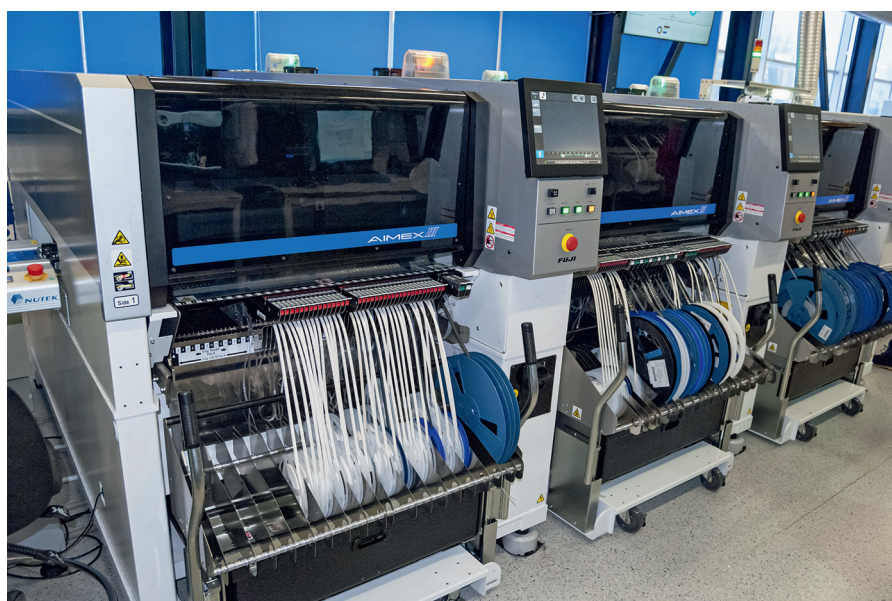
Автоматы установки компонентов AIMEX III компании Fuji
