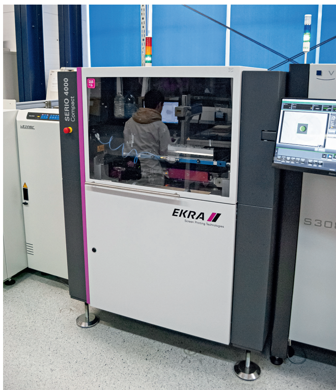
Установка трафаретной печати Ekra Serio 4000 Compact в линии
