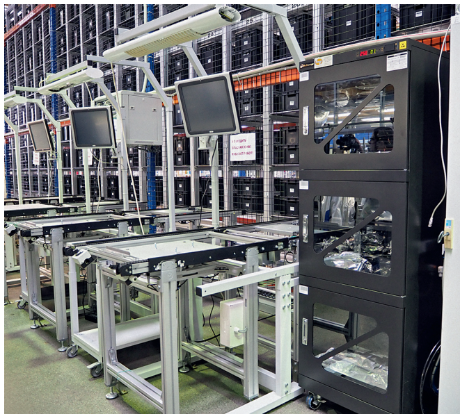
Склад компонентов. На переднем плане справа – шкаф сухого хранения
