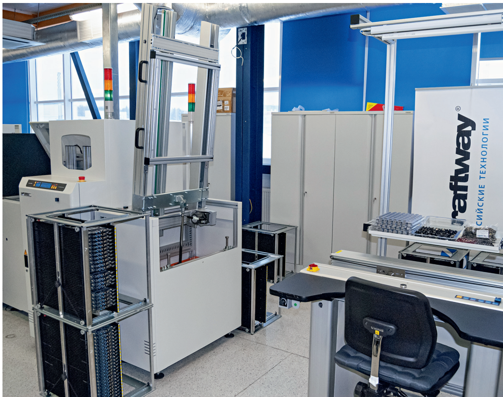
Конвейер-ворота между частями линии, где выполняется поверхностный монтаж и монтаж в отверстия
