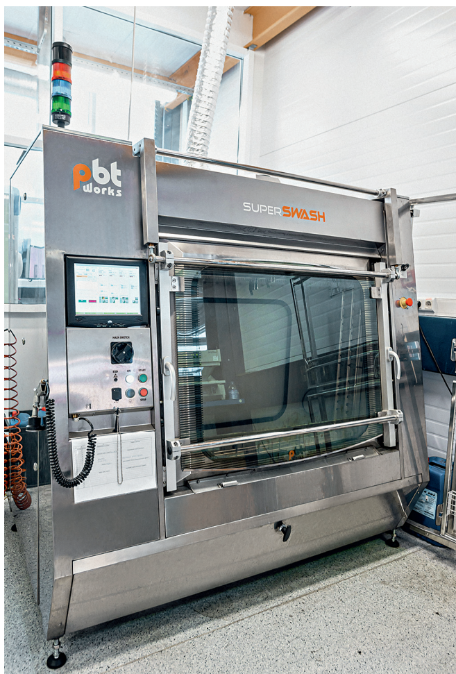
Установка отмывки SuperSwash компании PBT Works
