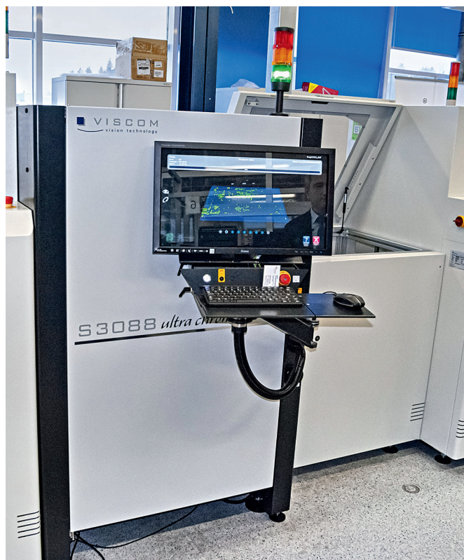
Система АОИ S3088 Ultra Chrome компании Viscom
