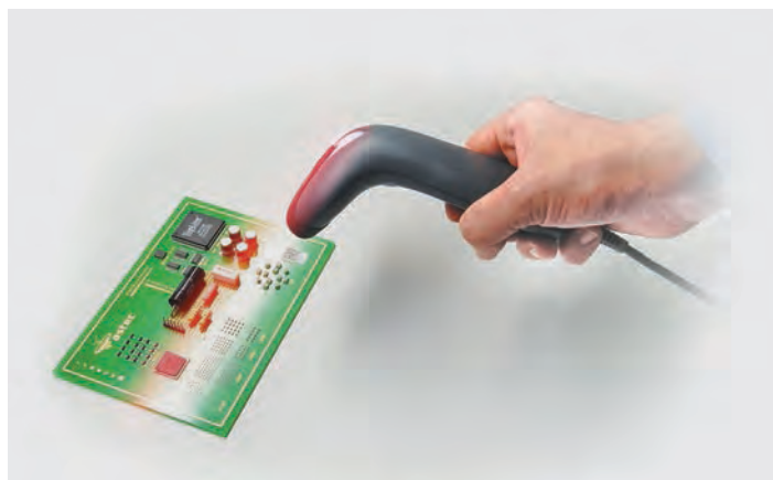
Считывание QR-кода с историей всех технологических операций по изделию
