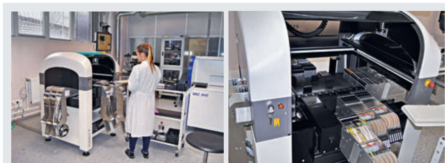
Автомат поверхностного монтажа Essemtec FLX 2011 V
