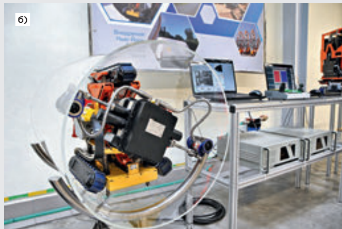
Производство ГК «Диаконт»: а – электромагнитные приводы различных типов; б – взрывозащищенное средство доставки, оснащенное визуальной камерой измерительного контроля
