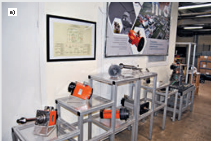
Производство ГК «Диаконт»: а – электромагнитные приводы различных типов; б – взрывозащищенное средство доставки, оснащенное визуальной камерой измерительного контроля
