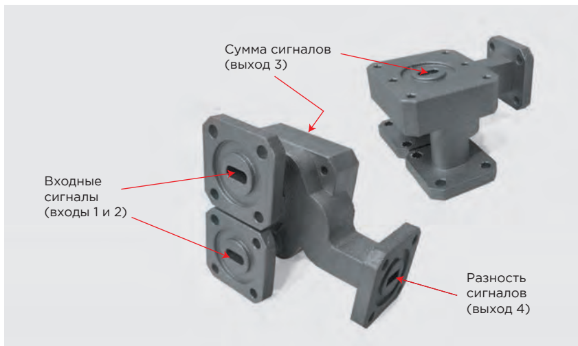
1 Фотография напечатанного сумматора. Габаритные размеры 41×39×54 мм
