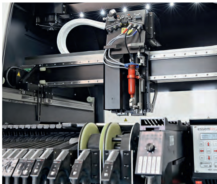
Универсальный сборочный центр Essemtec Fox: дозирование и установка
