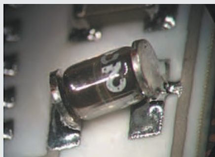
Близкое расположение дорожки к площадке
