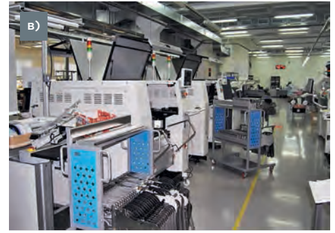
Смена питателей в старых и новых автоматах Samsung: а – подкатные тележки для SM421 и SM451; б – сменные базы питателей для SM471 Plus и SM481 Plus; в – за подкатной тележкой можно видеть сменную базу, подключенную к установщику SM481 Plus
