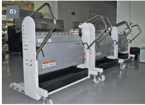
Смена питателей в старых и новых автоматах Samsung: а – подкатные тележки для SM421 и SM451; б – сменные базы питателей для SM471 Plus и SM481 Plus; в – за подкатной тележкой можно видеть сменную базу, подключенную к установщику SM481 Plus
