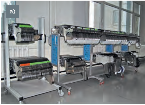
Смена питателей в старых и новых автоматах Samsung: а – подкатные тележки для SM421 и SM451; б – сменные базы питателей для SM471 Plus и SM481 Plus; в – за подкатной тележкой можно видеть сменную базу, подключенную к установщику SM481 Plus
