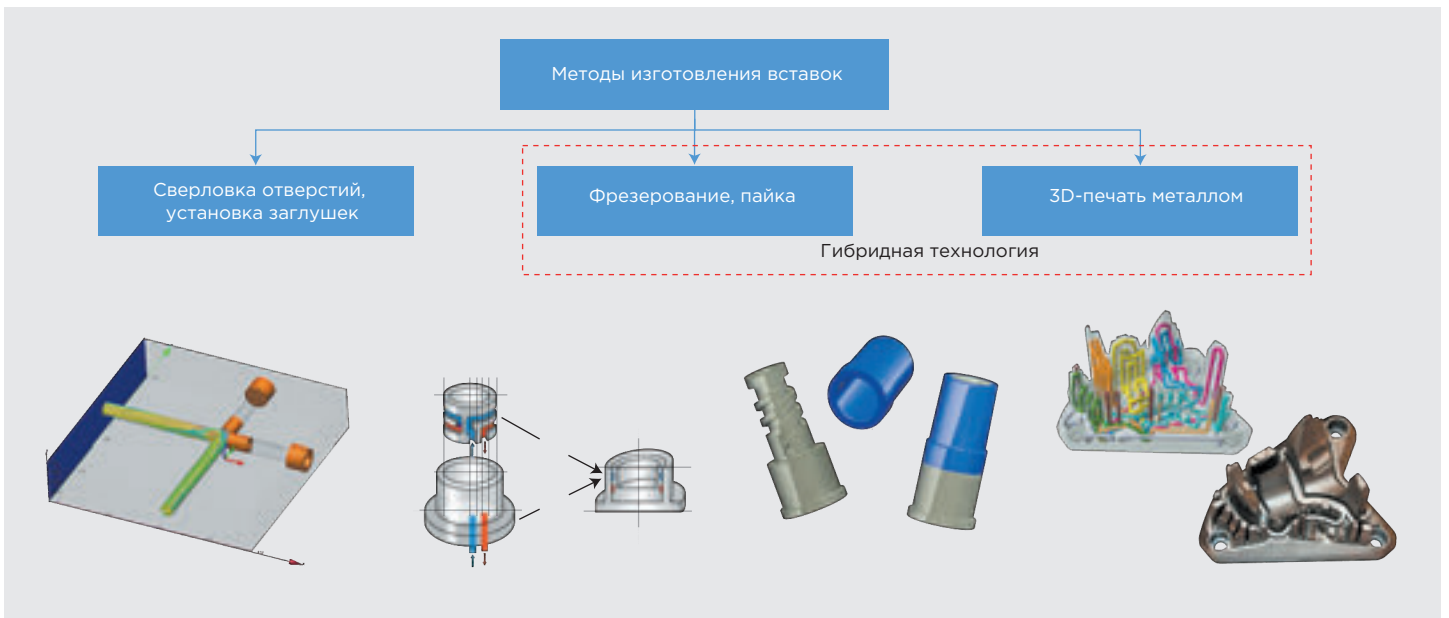
9 Группы методов изготовления вставок в формы с каналами охлаждения
