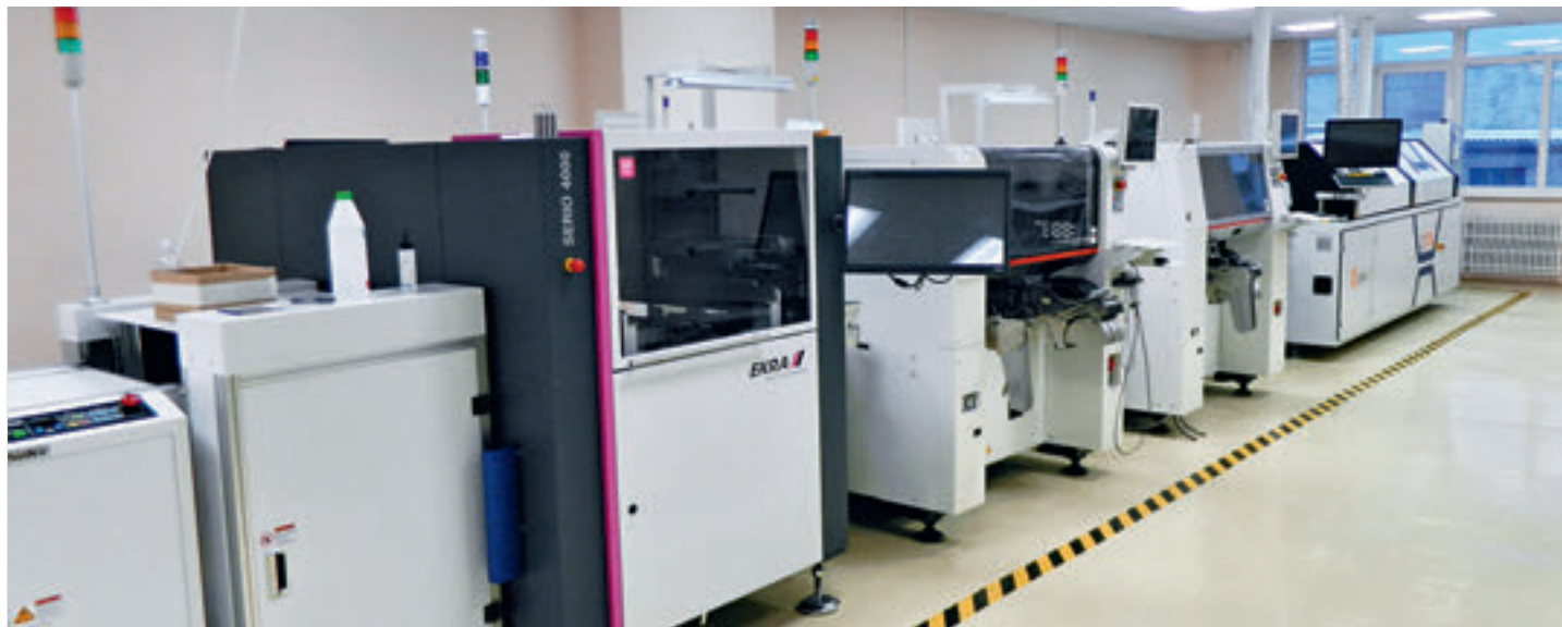
1 Сборочно-монтажная линия с максимальной производительностью до 110 тысяч комп./час
