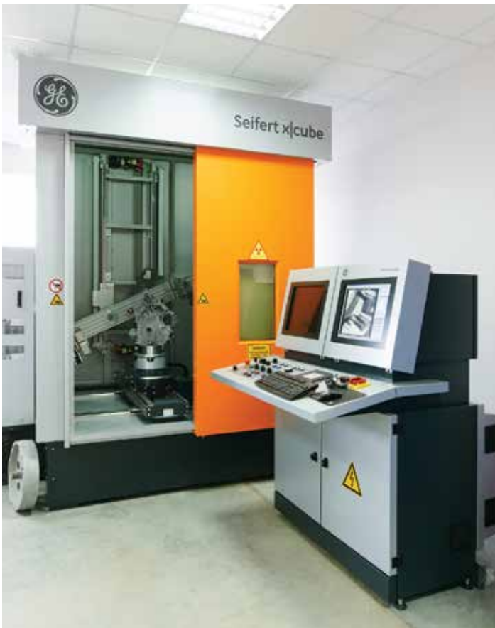
4 2D-исследование крышки картера в рентгеновской установке X-Cube XL 225 на наличие внутренних трещин и пустот
