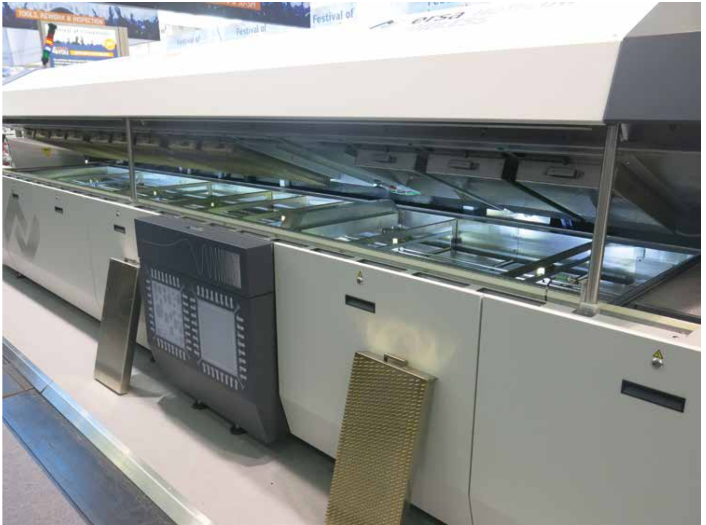
3 Печь оплавления Hotflow 4/20 со встроенным модулем «безпустотной пайки»
