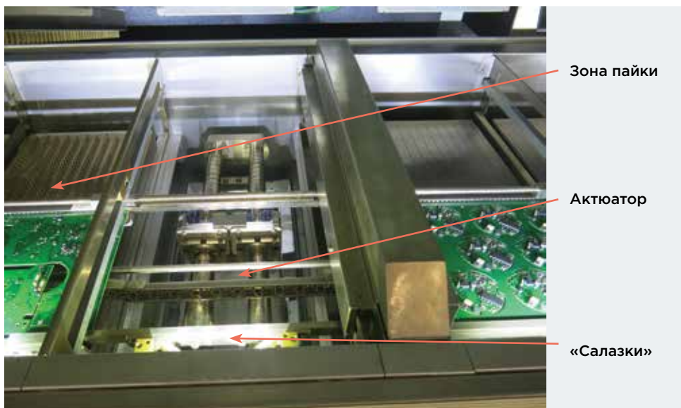
4 Зона удаления пустот из паяных соединений в печи Hotflow 4/20
