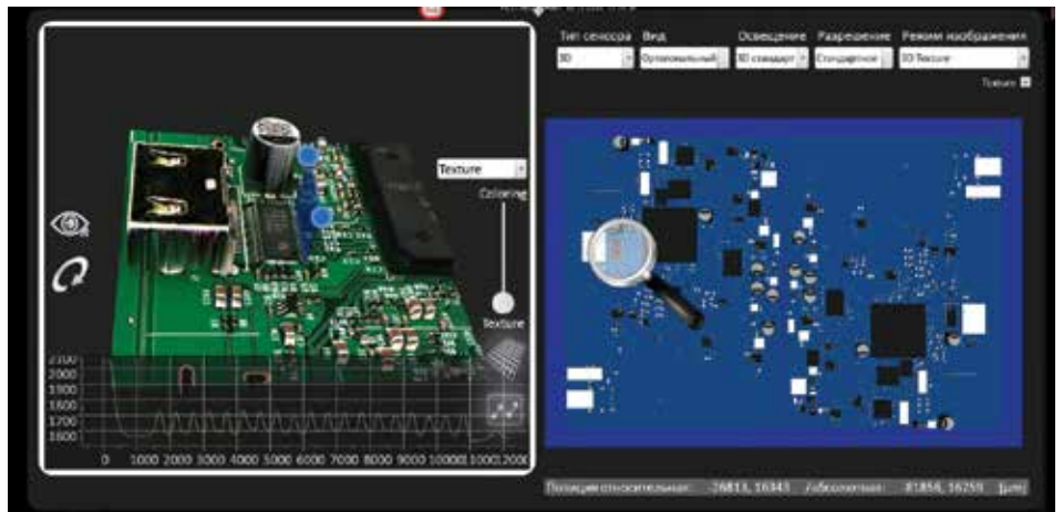
8 Работа с 3D изображением участка печатного узла. Измерение высоты галтели
