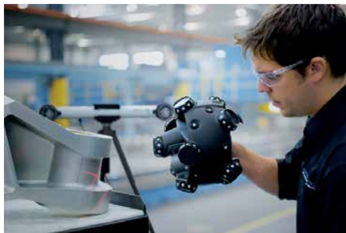
19 Сканирование изделия сканером MetraSCAN без использования меток на объекте
