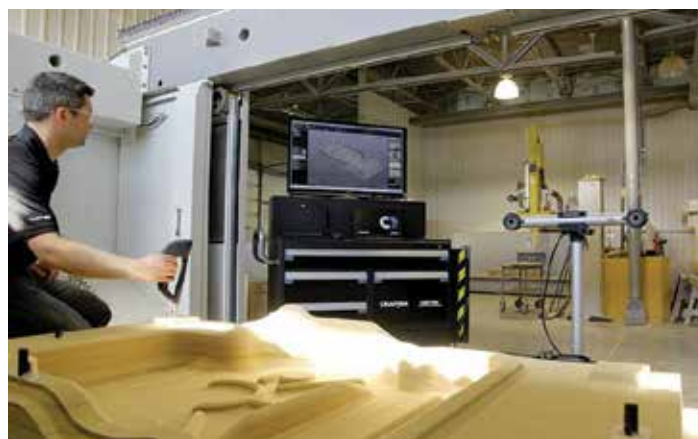
18 Измерение крупногабаритного объекта с помощью беспроводного зонда HandyPROBE
