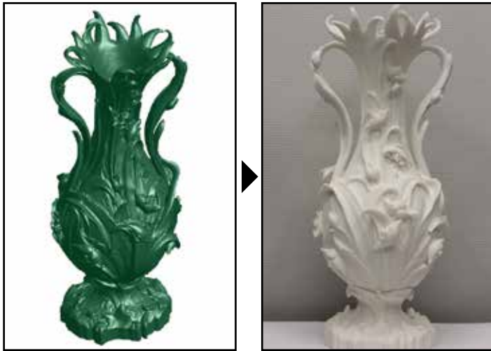
14 Создание цифровой модели вазы с последующей печатью на 3D-принтере VoxelJet VX500
