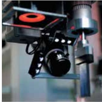
ной до 4,5 мм и массой до 3 кг. Трехосевое устройство захвата этикеток оснащено системой быстрой смены инструмента и позволяет выполнять операцию в любой плоскости относительно обрабатываемого изделия.
