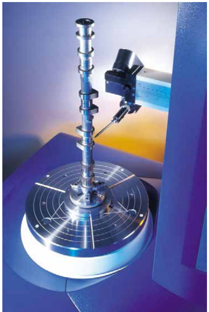
4 Измерение распределительного вала на кругломере
