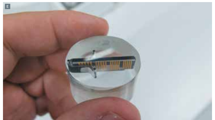
Аналитическая лаборатория: установка рентгенфлуоресцентного анализа FISCHERSCOPE X-RAY XDV компании Fischer Technology A , оборудование для металлографических исследований: микроскоп с видеокамерой B , установка полировки C , пресс заливки образца в пластик D , подготовленный для исследований срез 3D-MID-детали, залитой в пластик E
