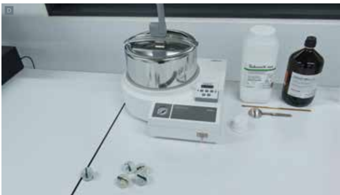
Аналитическая лаборатория: установка рентгенфлуоресцентного анализа FISCHERSCOPE X-RAY XDV компании Fischer Technology A , оборудование для металлографических исследований: микроскоп с видеокамерой B , установка полировки C , пресс заливки образца в пластик D , подготовленный для исследований срез 3D-MID-детали, залитой в пластик E
