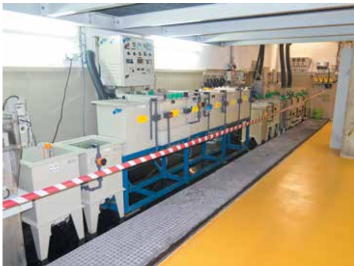
Участок электрохимической металлизации: экспериментальная линия (слева), основная линия с автоматической системой перемещения плат (справа)
