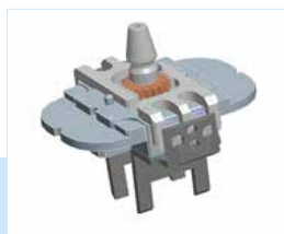
4 Технические решения автомата SM-451, позволяющие устанавливать нестандартные и штыревые компоненты
