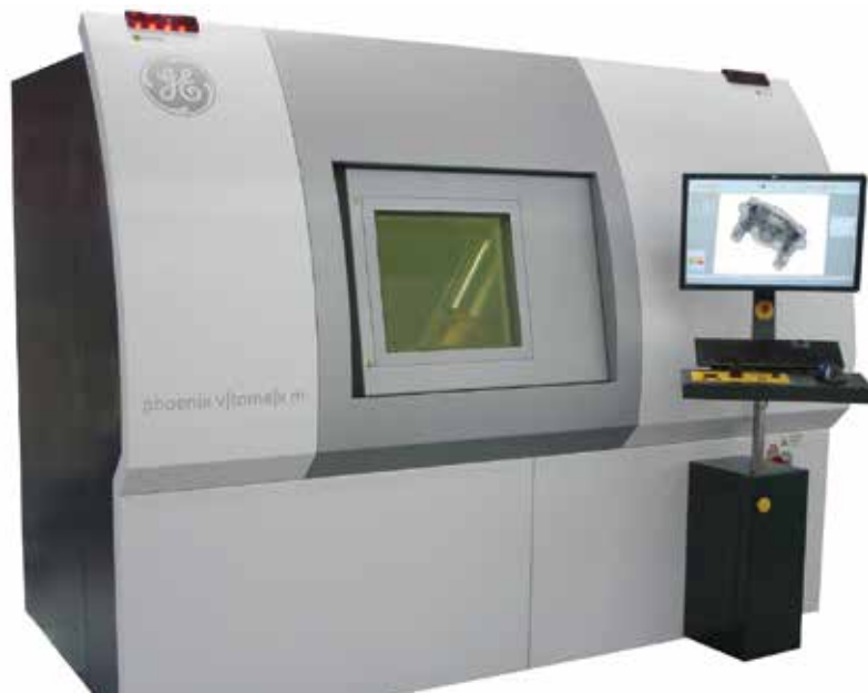
4 Внешний вид установки v|tome|x m. Благодаря мощной микрофокусной трубке КТ-система v|tome|x m подходит для получения томограмм высокого разрешения сильнопоглощающих компонентов с высоким увеличением
