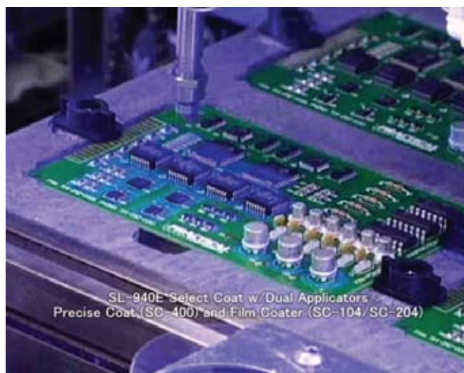
Рис. 7 Пленочное нанесение влагозащитного материала с помощью аппликатора SC204
