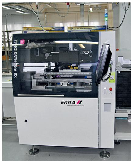
Установка трафаретной печати с функцией дозатора X5 Professional от компании Екра (входит в состав группы Asys) в третьей линии поверхностного монтажа
