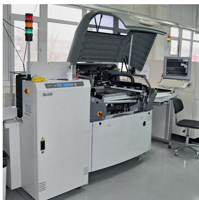
Загрузчик от компании Nutek и установка трафаретной печати DEK в первой линии поверхностного монтажа
