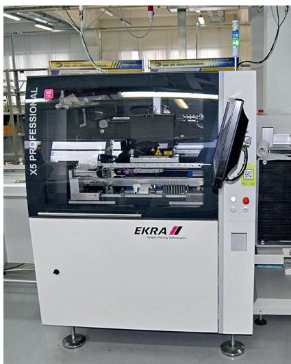
Установка трафаретной печати с функцией дозатора X5 Professional от компании Ekra (входит в состав группы Asys) в третьей линии поверхностного монтажа
