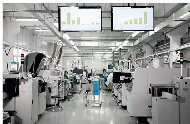
Общий вид на автоматизированные линии поверхностного монтажа на сборочно-монтажном производстве АО «ПО «Электроприбор»
