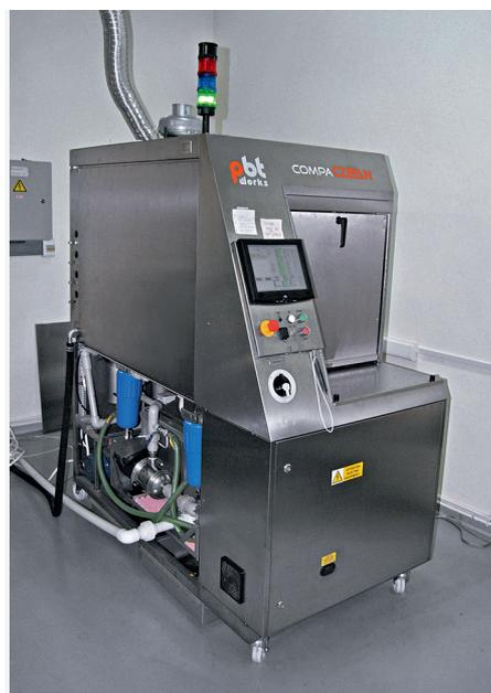
Системы струйной отмывки от компании PBT Works: слева – установка с загрузкой на раме SuperSwash, справа – установка с корзиной загрузкой CompaClean
