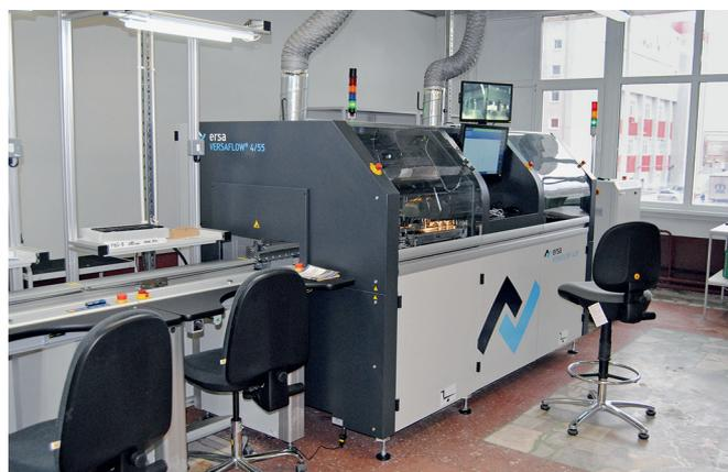
Система селективной пайки Ersal Versaflo 4/55. На переднем плане слева – рабочие места установки штыревых компонентов перед пайкой
