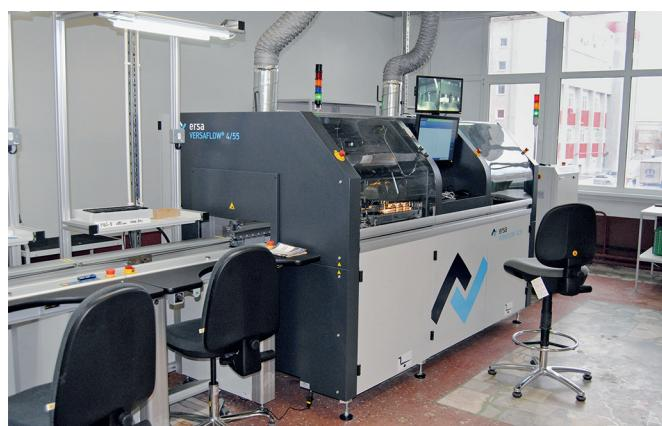
Система селективной пайки Ersa Versaflow 4/55. На переднем плане слева – рабочие места установки штыревых компонентов перед пайкой
