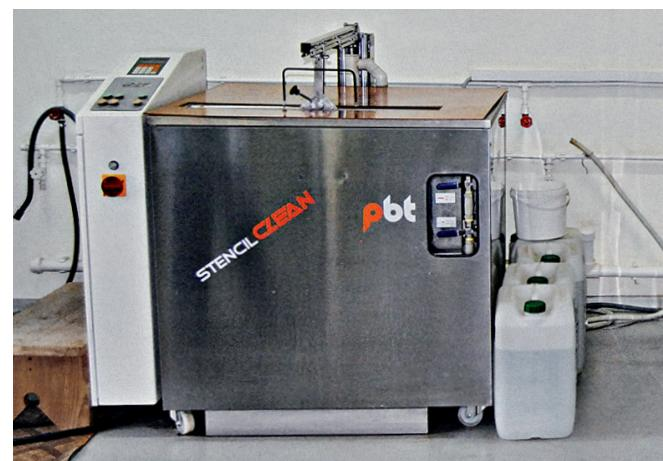
Установка отмычки трафаретов PBT Works StencilClean
