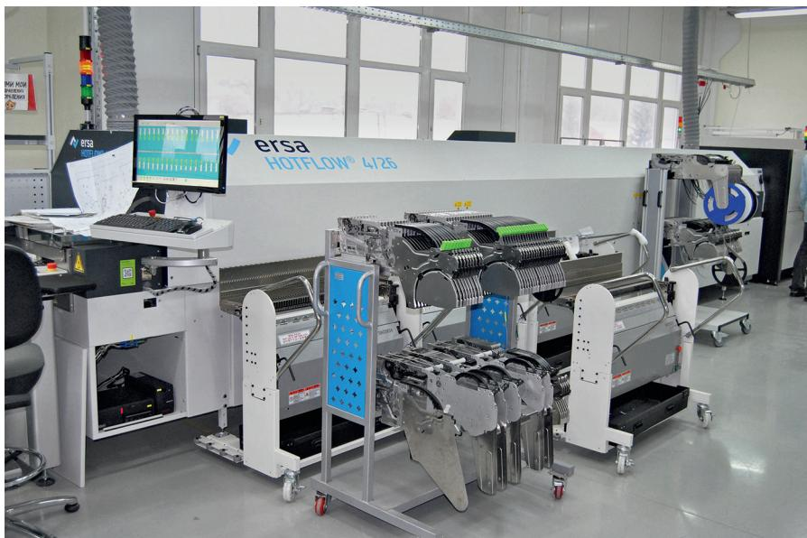
Печь Ersa Hotflow 4/26 в четвертой линии. На переднем плане видны подкатные тележки и сменные базы питателей
